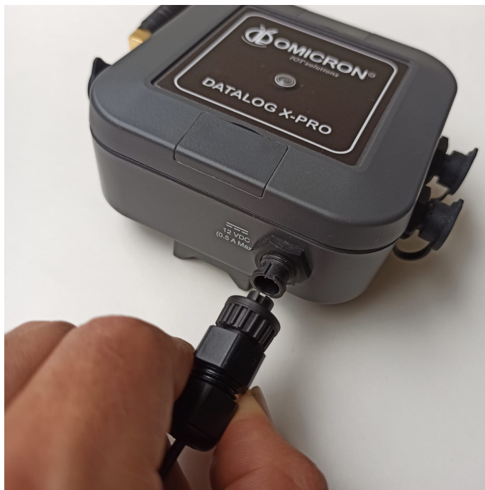
Figura 2-2 Conexión del adaptador AC/DC
