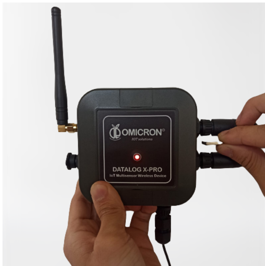
Figura 2-5 Posición correcta para colocar el imán de programación cerca del Datalog X-PRO
