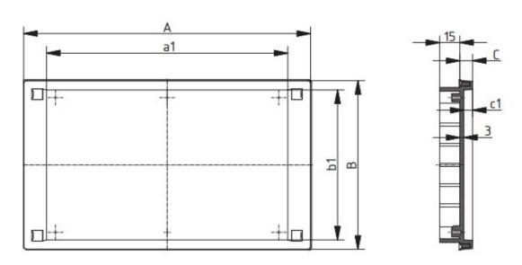
$Material: ABS \ (IP54). \ A=166mm \ B=106mm \ C=9.5mm \ a1=131.3mm \ b1=92.3mm \ c1=6.5mm.$
